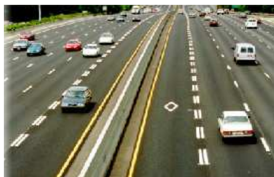
Carriles VAO separados por mediana + pintura Dos carriles dos sentidos
